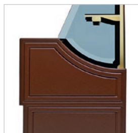
Lateral de la vitrina en plástico termoformado ABS color marrón.
