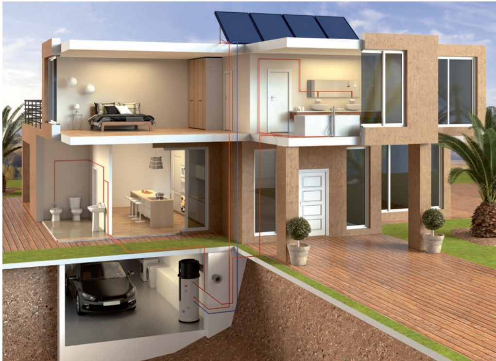
Acumulador ubicado en el garaje apoyado con energía solar y conectado a la red eléctrica doméstica.
